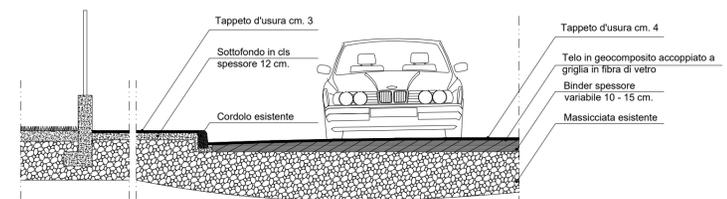
Sezione tipo di progetto in rotonda
