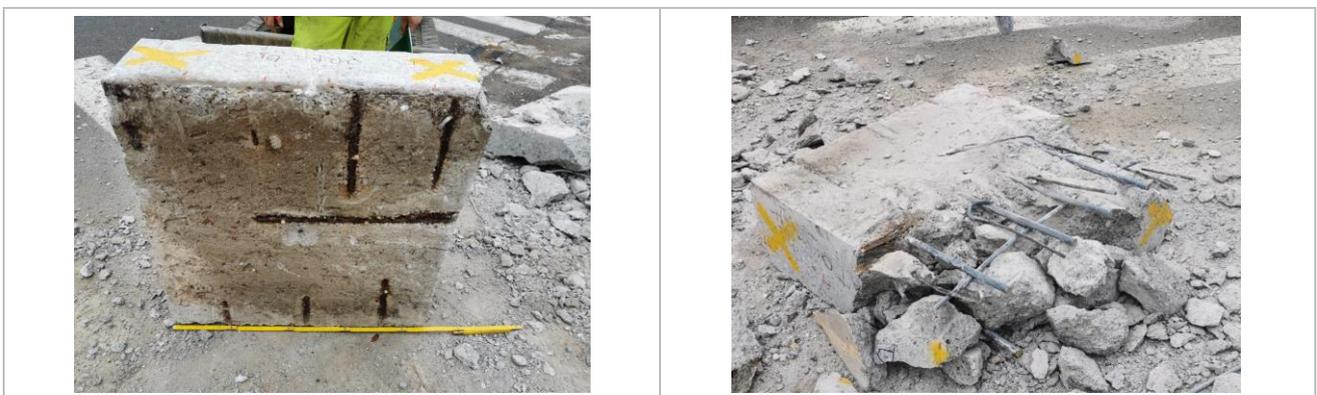
*Figura 13 – Ispezioni soletta di copertura posizione 3 (via Magenta)*
